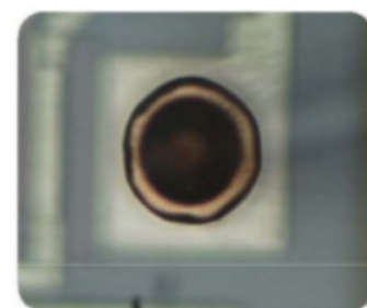
一普合金线稳定的第一焊点形状
