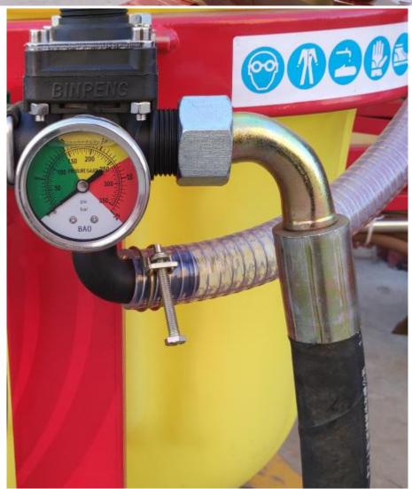
8. 调整压力大小,压力表不要压力不要超过红色显示区域,否则压力过大将损坏机器。Adjust the pressure, the pressure should not
