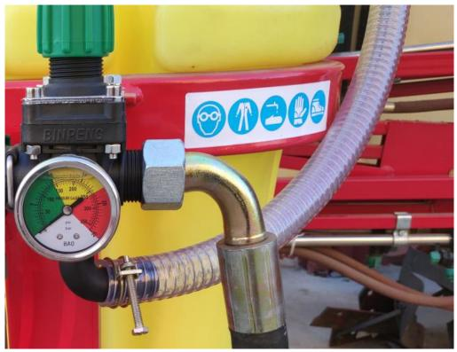
5. 过滤杯固定在机架的最下面,用透明钢丝管连接过滤杯和药泵上的弯头,另一段透明钢丝管安装在药箱最底部的接头上和过滤杯的直
