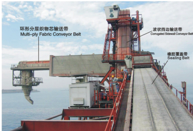
港口装船机 用于港口：带宽2000mm 挡边高500mm 基带：钢丝绳芯基带
