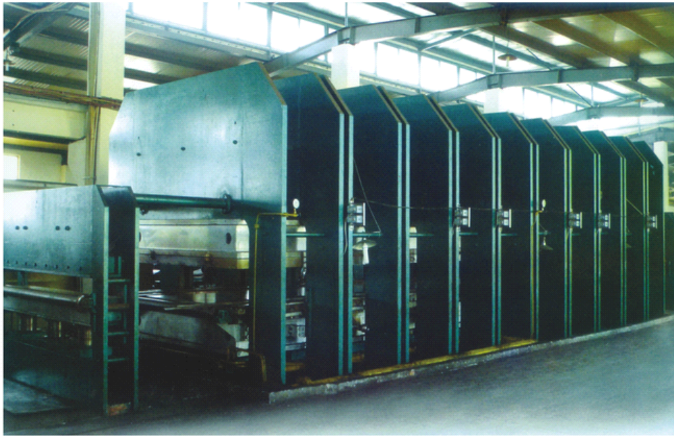
B2700mm×11m 大型钢丝绳输送带平板硫化生产线
