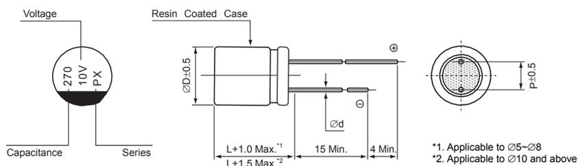
CONDUCTIVE POLYMER ALUMINUM SOLID ELECTROLYTIC CAPACITORS
