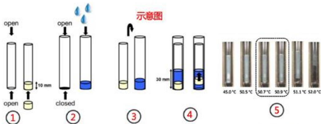
装样 → 装水柱 → 大管套小管 → 装入测试 → 测试效果
