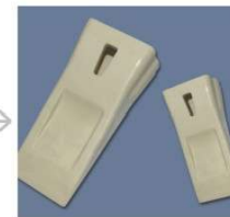
▲ Wax Model Manufacturing 制作蜡模
