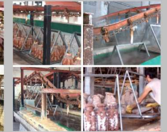
▲ Dewaxing Line 失蜡流水线
