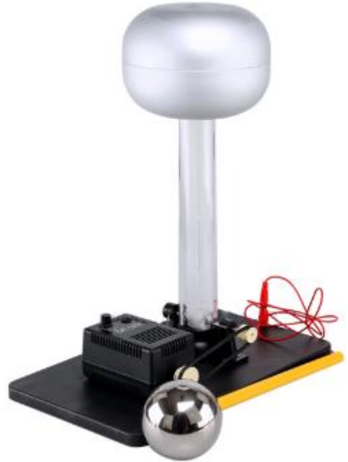
HSPE-006 Small Van De Graaff Generator
